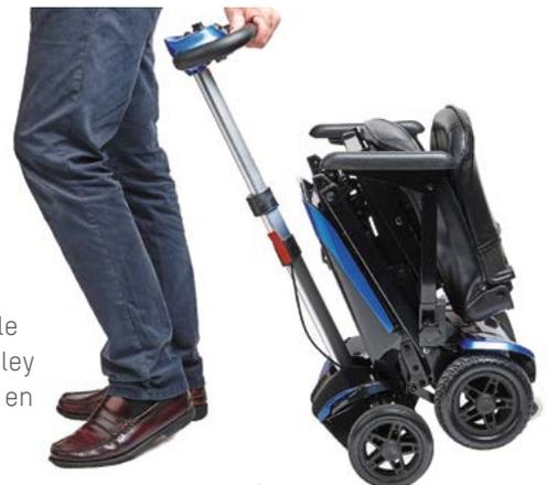
4. Transportable como un trolley apoyándose en las ruedas delanteras.
