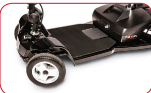
20,3 cm (8") Ruedas Delanteras Más Grandes y Cubierta Delantera de Nuevo Diseño
